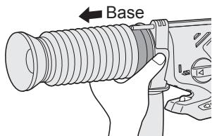
Extrágalo después de haber retirado completamente el polvo acumulado en el colector de polvo.
