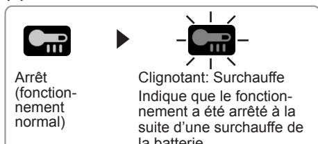
La caractéristique de protection contre la surchauffe arrête le fonctionnement de l'outil afin de protéger la batterie autonome en cas de surchauffe. Le témoin d'avertissement de surchauffe clignote sur le panneau de commande lorsque cette caractéristique est active.
