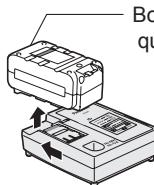
9. Extraiga la batería mientras mantiene levantado el botón de desbloqueo de la batería.
