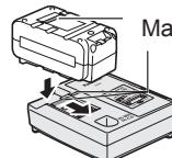
3. La luz indicadora de carga permanecerá encendida durante la carga. Cuando haya terminado la carga, se accionará automáticamente un conmutador electrónico interno para impedir cualquier sobrecarga.
