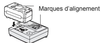
3. Pendant la charge, le témoin s'allume. Lorsque la charge est terminée, un interrupteur électronique s'actionne pour protéger la batterie.
