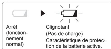
Une décharge excessive (totale) des batteries aux ions de lithium réduit leur durée de vie de façon notable. Le marteau rotatif comprend une caractéristique de protection de la batterie conçue pour empêcher une décharge excessive de la batterie autonome.
