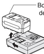
9. Retirez la batterie lorsque le bouton de dégagement de la batterie est en position haute.
