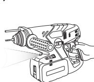
Appuyez sur pour allumer et éteindre la lumière DEL. La lumière éclaire avec un courant de très faible intensité qui n'affecte pas négativement la performance du tournevis ou la capacité de la batterie pendant son utilisation.
